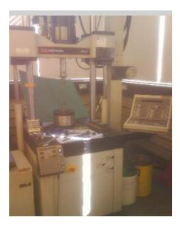
Fig: 4.9. Instron series 9 test rig.
