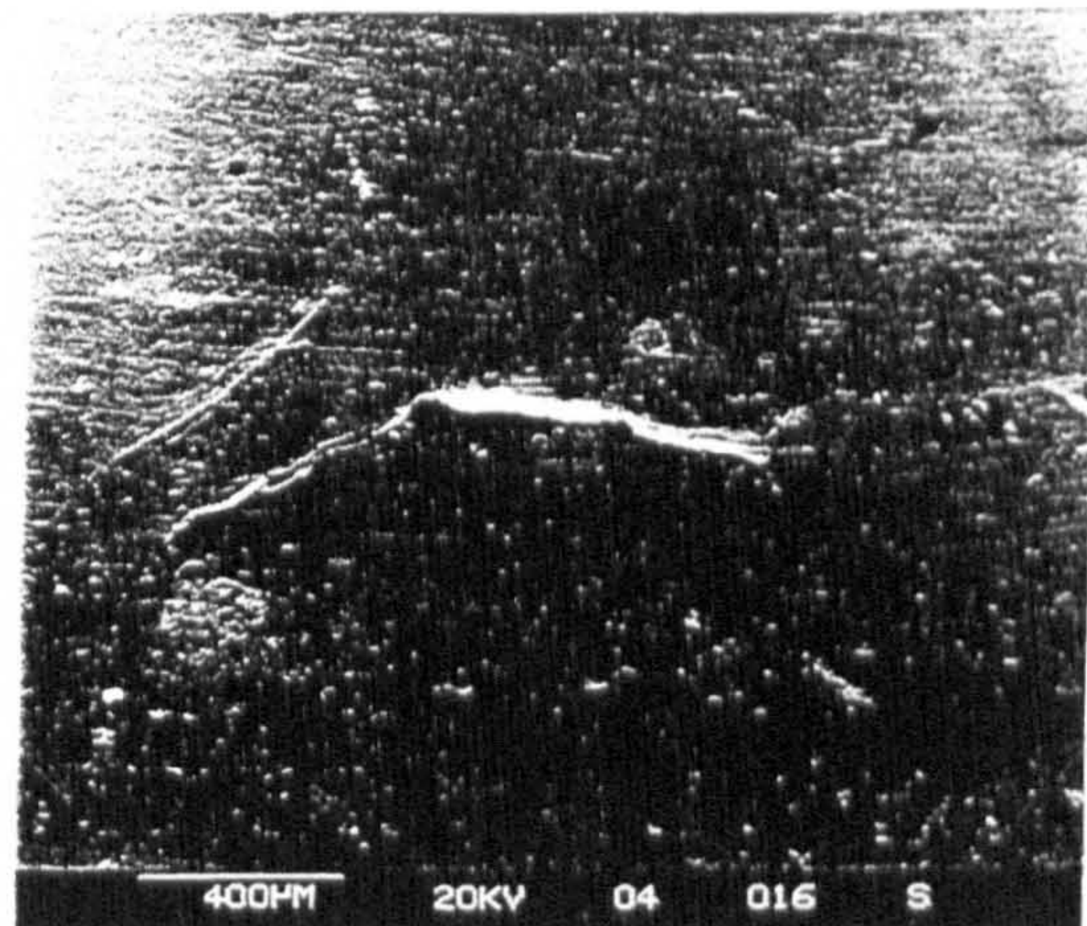
(d) edge crack end
