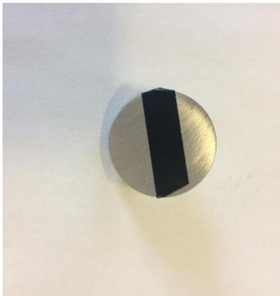
(d) Attachment of double sided conductive carbon adhesive tape
